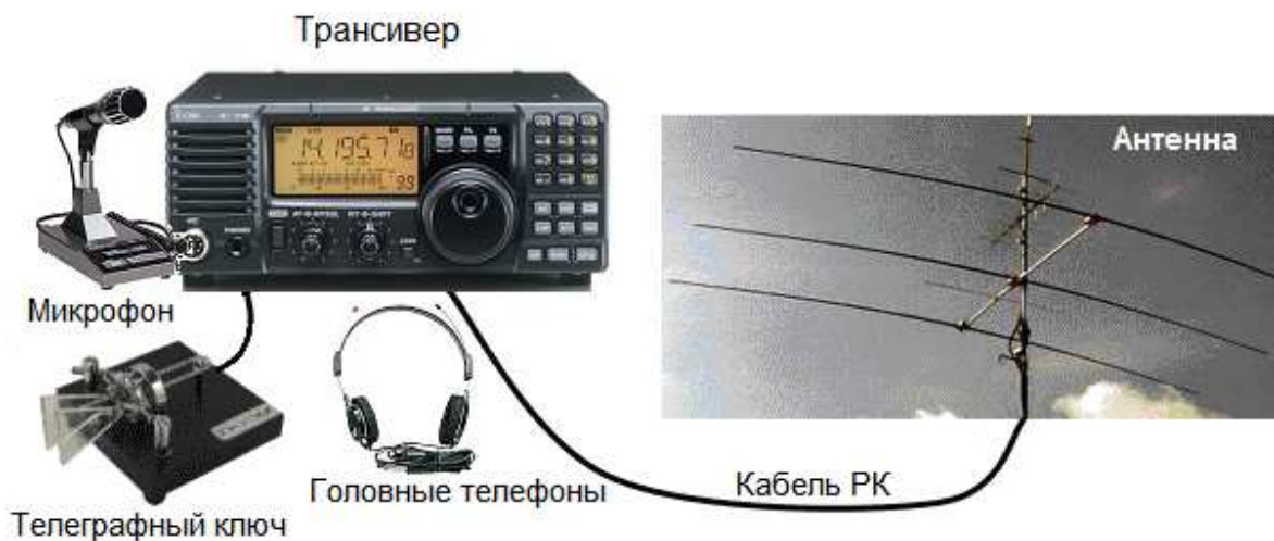
Рис.2.2. Элементы любительской радиостанции
