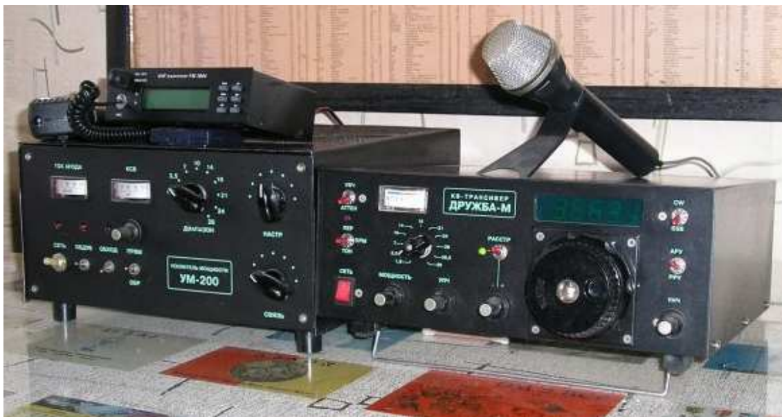
Рис.2.6. Трансивер «Дружба-М» и усилитель мощности «УМ-200»
